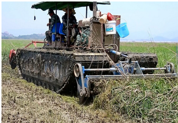
图 6 履带式机械割草机
